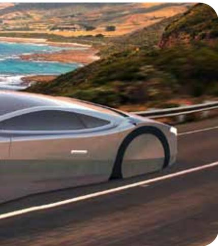
**(Ganz links) Im Projekt TUM Create haben Entwickler aus 20 unterschiedlichen Nationen das Elektrotaxi Eva entwickelt, speziell für tropische Megacities. Der Kompaktwagen mit Steilheck ist 4,32 Meter lang, 1,79 Meter breit, und 1,68 Meter hoch. Eva wurde bereits auf der Straße erprobt.**
