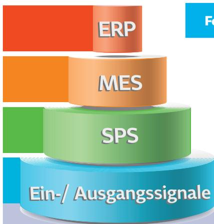
**3** Bei der Lehr- und Forschungsplattform ‚MPS Transfer Factory‘ von Festo kommunizieren die integrierten SAP-Anwendungen ERP und MES über direkte Schnittstellen mit der Produktionsanlage und zeigen, dass der Einsatz von Leitrechnern als Vermittlungsebene zwischen der Auftragsverwaltung und der Produktionsanlage nicht mehr zwingend nötig ist. Doppelte Datenhaltung und inkonsistente Datenbestände gehören somit der Vergangenheit an. Quelle: Festo
